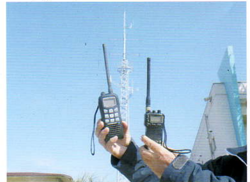
右が古いマリンVHF無線機 左が新しい国際VHF無線機
